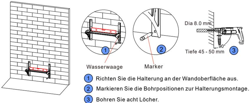
Abbildung 4-9: Bestimmung der Bohrpositionen für die Wandhalterung
